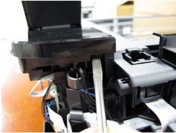
松开 LCD 操作板背面的上罩反面的螺丝。
