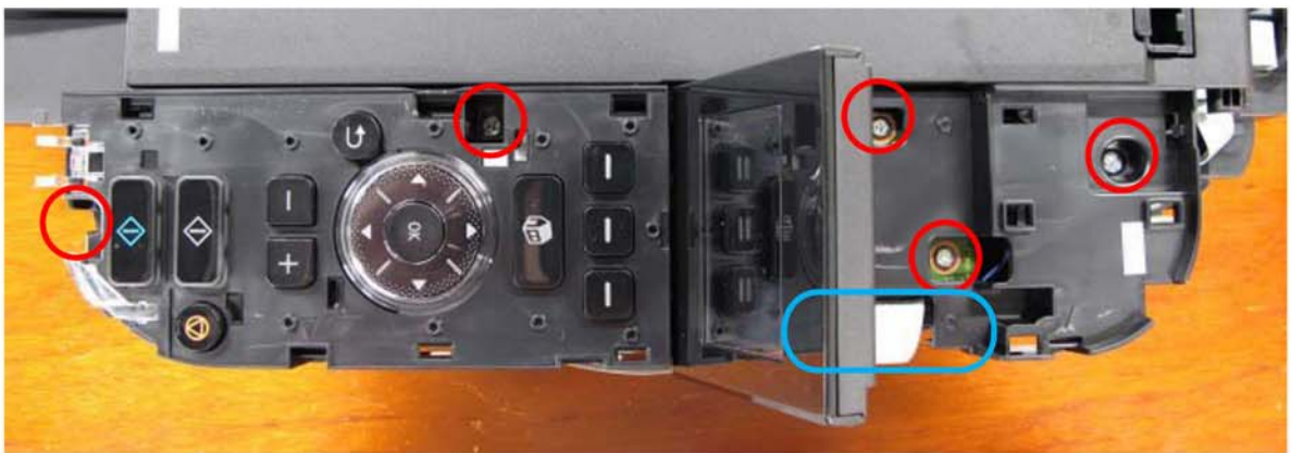
松开控制板面上的 5 个螺丝。
