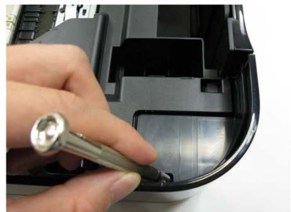
使用平口螺丝锥往小洞里施力来松开卡口。
