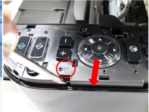
在标记 ▼ 的位置，如图中红色标识圈所示，向外推侧盖卡口，然后移除侧盖。
