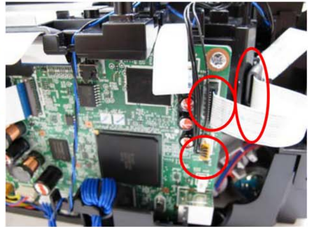
断开 FFC 和线束，拆除红圈标识的线束。
