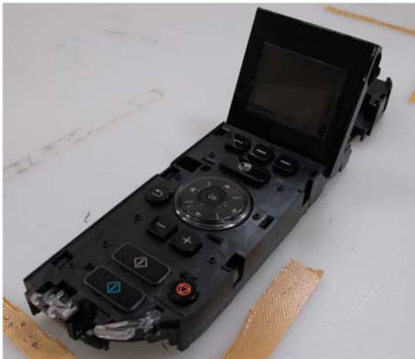
松开控制板面上的 5 个螺丝。
